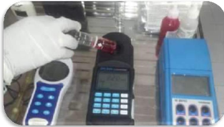
Equipos para el análisis de parámetros físico químicos del agua potable
