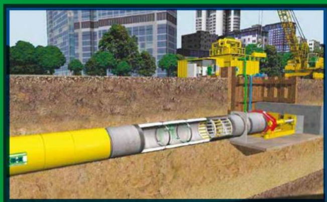
Figura del procedimiento de la Tuneladora instalando tubos en forma subterránea.
