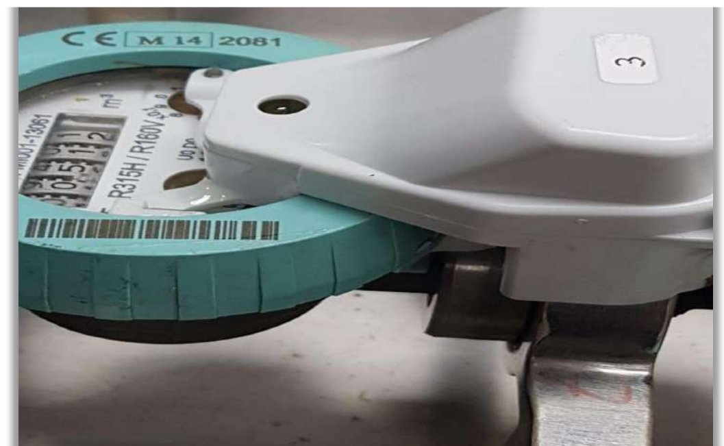
Implementación de infraestructura de Medición Avanzada (AMI): Dispositivo tecnológico adherido al medidor de acueducto
