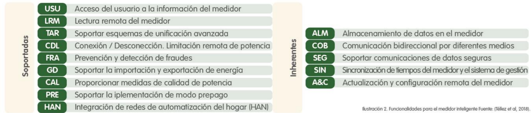
Ilustración 2. Funcionalidades para el medidor inteligente Fuente: (Téllez et al, 2018).
